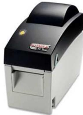
Sus características técnicas como Impresión térmica directa, resolución de impresión de 203 dpi, una velocidad de impresión de 100 mm por segundo, un CPU de 32 bits, Memoria de 8Mb SDRAM y Mb de Flash, Soporta un ancho máximo de impresión de 54 mm y un ancho de papel de 60 mm. Gracias al sensor de papel alineado al centro detecta espacios entre etiquetas, marcas de color negro y muescas. Admite papel o etiquetas en rollo, continuo o tickets.
